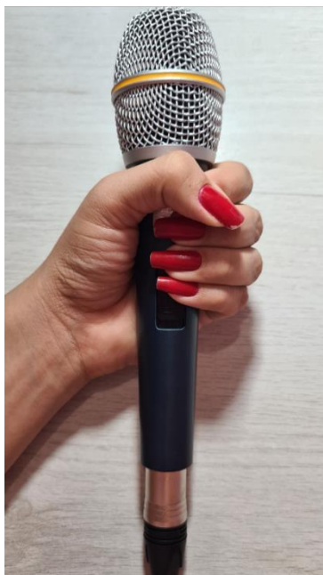
Imagem 9 - modo de segurar o microfone com a mão posicionada logo abaixo da cápsula e em cima do interruptor on/off .
