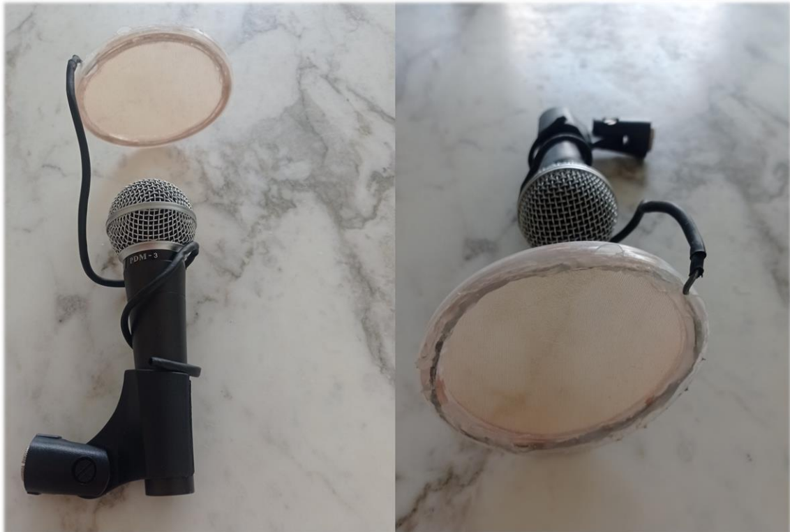
Figura 8: Exemplo de pop filter caseiro, construído por membro do grupo
