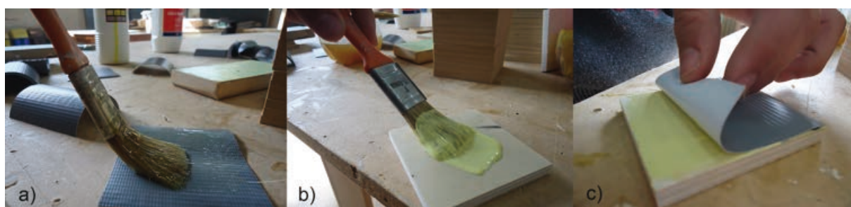
Figura 3 – Testes de união com adesivos: a) aplicação da cola de contato na face com textura da lona; b) aplicação da cola de madeira na superfície do MDF; c) união entre a face lisa da lona e a superfície da madeira, com cola para madeira
