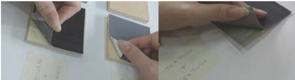
Figura 5 – Resultados da aplicação dos adesivos: a) cola de contato aplicada na parte posterior da lona e na madeira; b) cola branca aplicada nas faces posteriores da lona; c) cola para madeira aplicada nas faces da lona com impressão.
