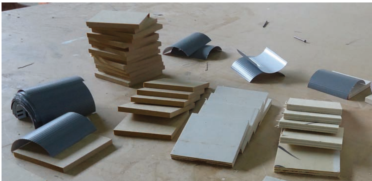
Figura 2 – Amostras de lona vinílica, de madeira e de MDF prontas para a aplicação dos adesivos para os testes de união
