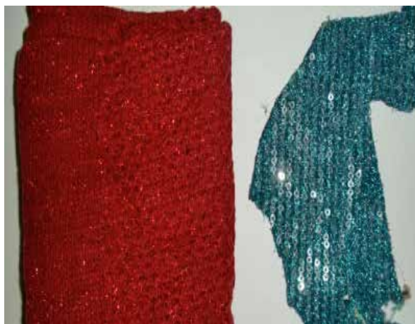
Figura 3 – Exemplos de amostras de resíduos têxteis separadas manualmente contendo fios e paetês metálicos e metalizados.
