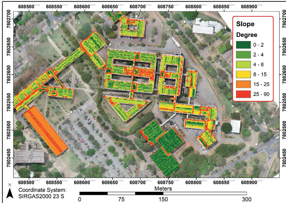
Figura 5 | Declividade dos telhados da EE-IGC-UFMG.
