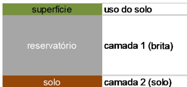
Figura 6 | Composição das camadas da estrutura de trincheira de infiltração representada no Swat para simulação.
