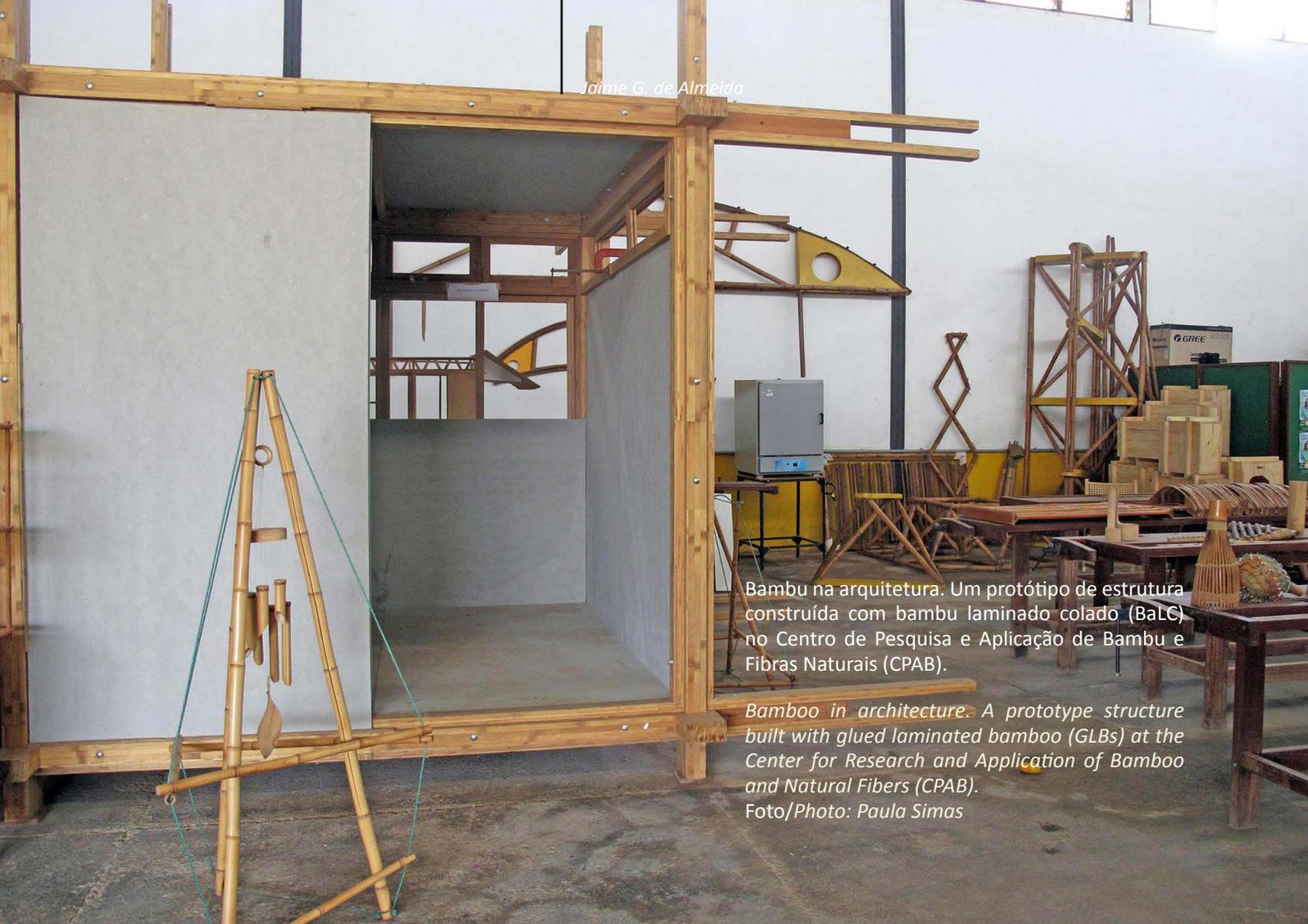
Bambu na arquitetura. Um protótipo de estrutura construída com bambu laminado colado (BaLC) no Centro de Pesquisa e Aplicação de Bambu e Fibras Naturais (CPAB).
