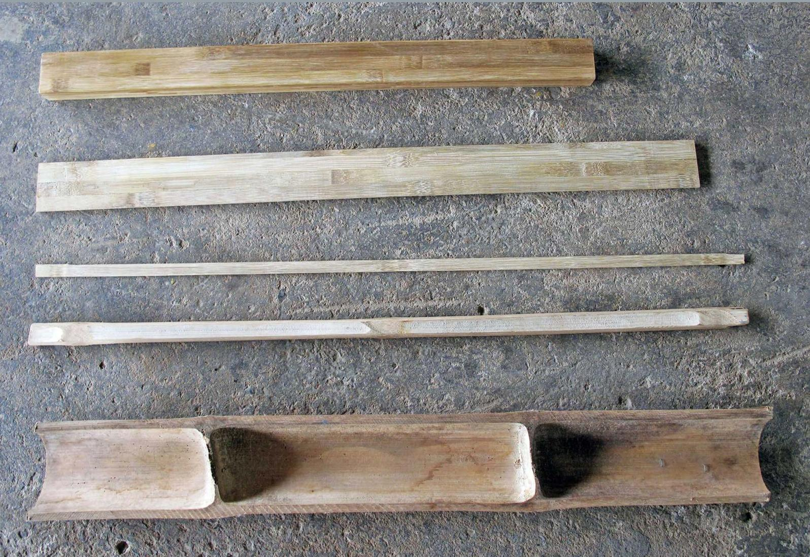
Principais etapas da produção do bambu laminado colado (BaLC): em primeiro plano, metade de uma parte do colmo do bambu gigante com dois nós; em seguida, uma ripa bruta e uma ripa aparelhada; depois, ripas coladas na forma chapa fina; e, finalmente, uma peça de BaLC finalizada.
