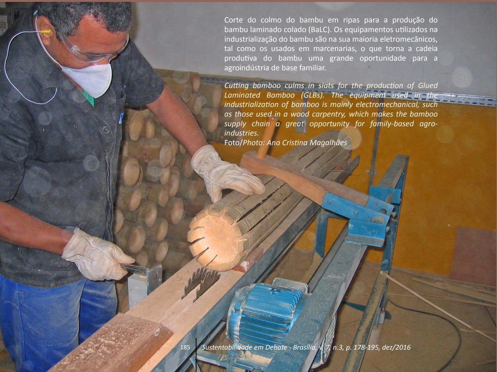
Corte do colmo do bambu em ripas para a produção do bambu laminado colado (BaLC). Os equipamentos utilizados na industrialização do bambu são na sua maioria eletromecânicos, tal como os usados em marcenarias, o que torna a cadeia produtiva do bambu uma grande oportunidade para a agroindústria de base familiar.
