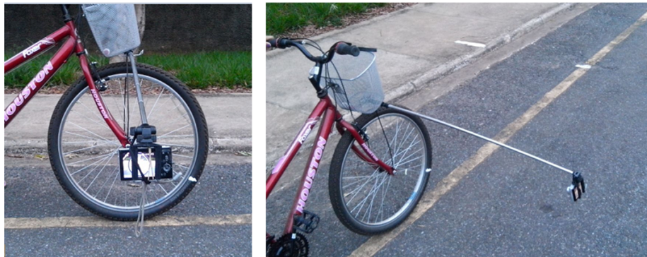
Figura 3: Filmagem da roda dianteira a partir do referencial solidário ao seu eixo de rotação. O suporte que liga bicicleta à câmera possui comprimento de 105,8 cm.
