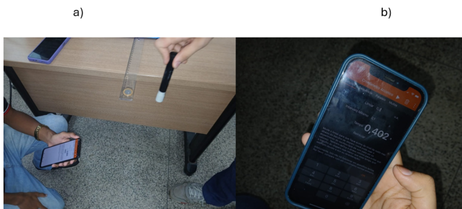
Figura 7: a) Dupla de uma das equipes executando o experimento. b) Uma medida de tempo da queda da moeda registrada pelo cronômetro acústico do Phyphox de uma das equipes. Fonte: Autor.
