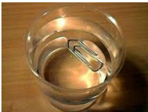
Figura 5: Demonstração da tensão superficial da água. Fonte: Para pais e professores (2025).
