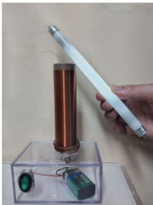
Figura 4: Lâmpada acendendo no primeiro teste da Mini Bobina de Tesla. Fonte: O autor
