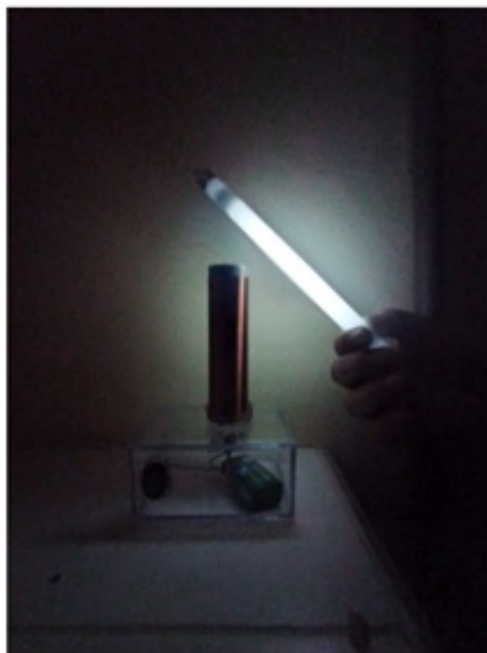
Figura 5: Mini Bobina de Tesla acendendo a lâmpada. Fonte: O autor
