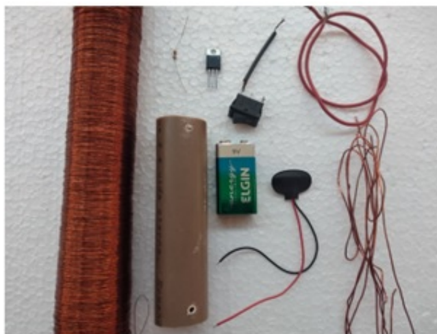
Figura 1: Materiais utilizados na construção da bobina. Fonte: O autor.
