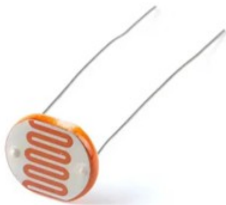
Figura 7: Componente eletrônico (LDR) utilizado em sistemas para iluminação pública. Fonte: BERTOLETI, Pedro. O que é LDR? Disponível (aqui). Acesso em: 19 mar. 2025
