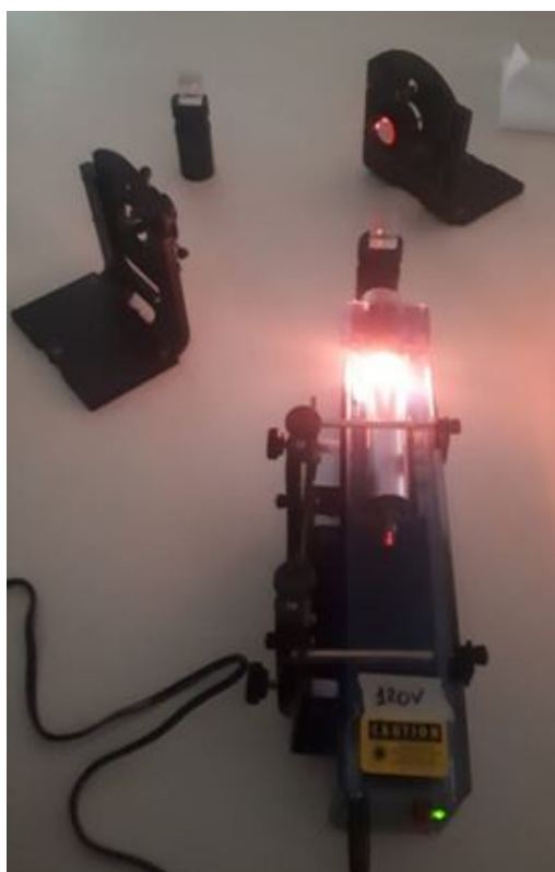
Figura 7: Interferômetro Mach-Zehnder. Fonte: Autoria própria (2024)
