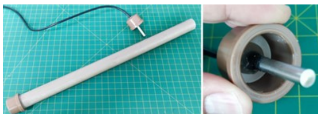
Figura 1: À esquerda o cano com um dos caps na extremidade e o outro cap com sensor próximo. À direita o cap sensor Ds18b20 em destaque.
