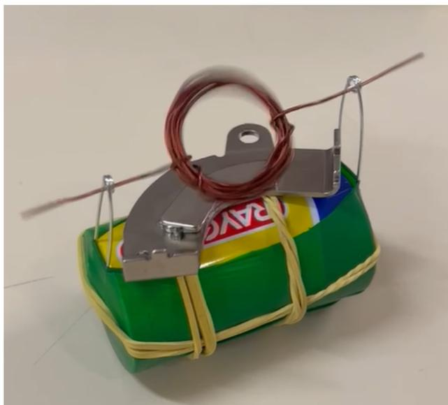
**Figura 1:** Motor elétrico produzido pelos educandos. Fonte: Os Autores (2024).
