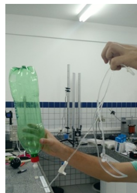
Figura 2: Construção no sistema de gotejamento por garrafa PET.
