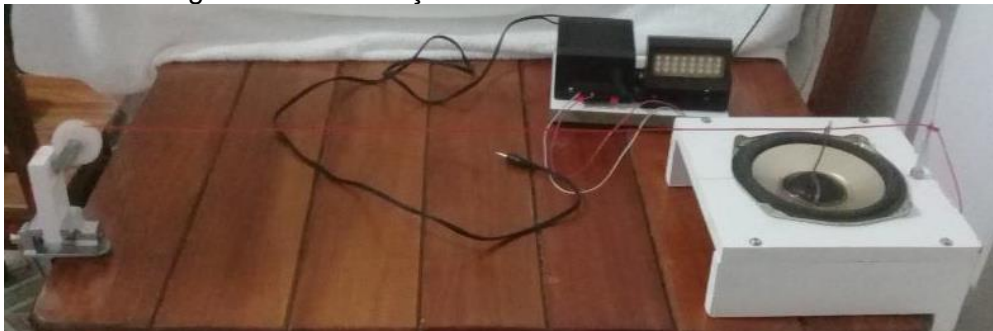
Figura 1: reconstrução do oscilador de Franz Melde.
