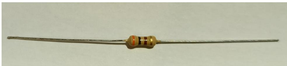
**Figura 1:** Resistor anéis coloridos
