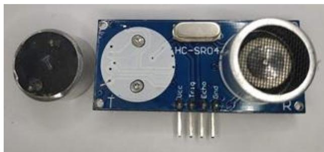
**Figura 5:** Detalhes do transdutor retirado do sensor ultrassônico.
