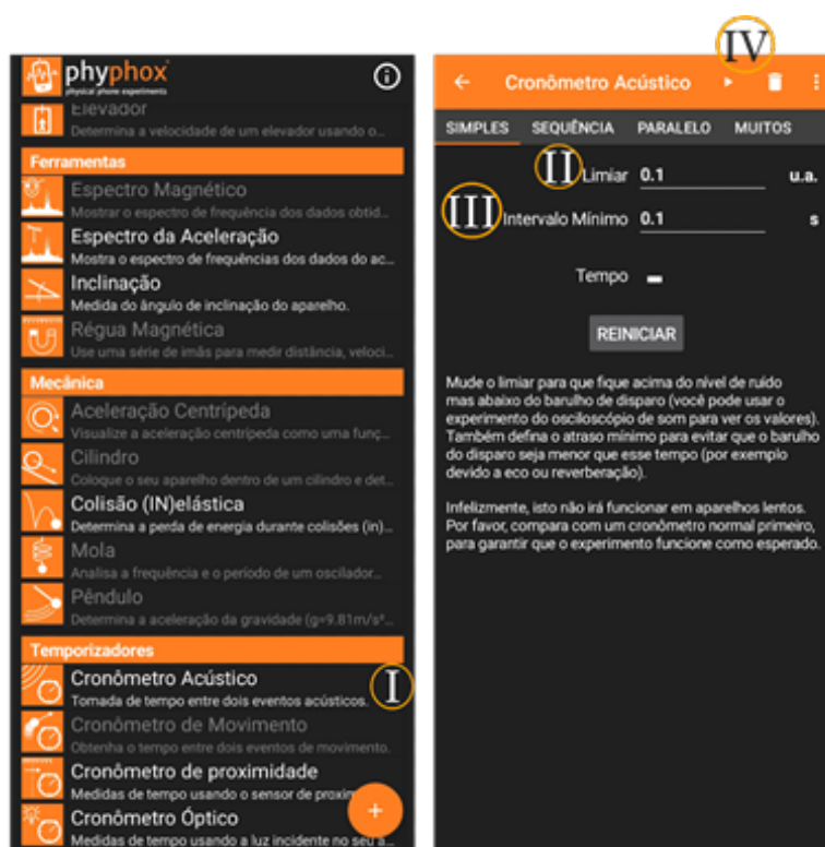
Figura 2: Imagens da plataforma do aplicativo Phyphox no smartphone: I. A função utilizada para esse experimento; II. O valor entre o nível do ruído e o barulho do disparo; III. Qual deve ser o atraso mínimo para pausar a coleta de dados; IV. Indica o botão para habilitar o cronômetro no aplicativo. Fonte: Elaboração dos autores (2022).
