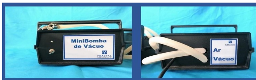
Figura 2: Fotografias da minibomba de vácuo, montada com um minimotor- compressor, fonte de alimentação e caixa plástica. Fonte: os autores
