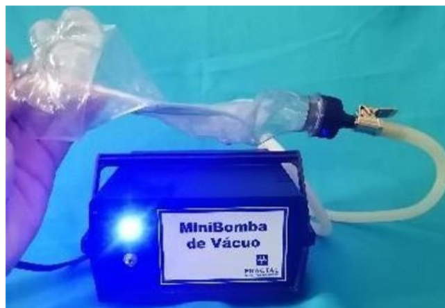
Figura 6: Fotografia de uma garrafa PET conectada à minibomba de vácuo já completamente sugada e com as paredes do plástico bem juntas. Fonte: os autores
