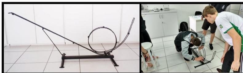
**Figura 2:** *Looping* à esquerda; Alunos medindo diâmetro da circunferência do *looping* à direita
