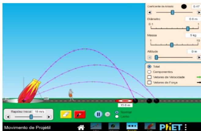
**Figura 3:** Simulação computacional *PhET* do lançamento de projéteis, onde é possível variar a velocidade inicial de lançamento, o ângulo de lançamento, a massa do objeto, o diâmetro do objeto, a aceleração da gravidade e o coeficiente de arrasto, considerando ou não a resistência do ar. É possível medir o alcance horizontal, o tempo de subida e de descida, a altura máxima, além de visualizar os vetores força peso e força de arrasto e suas componentes.
