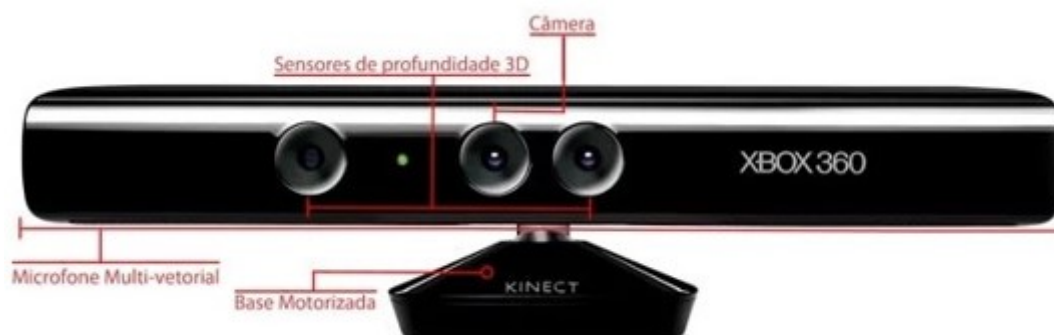
Figura 1: Kinect e cada um dos seus sensores. A câmera RGB, os microfones e os sensores de profundidade.
