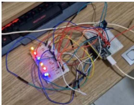
Figura 10. Sistema físico projetado para 4 vagas - ESP32, LEDs e buzzer utilizados.
