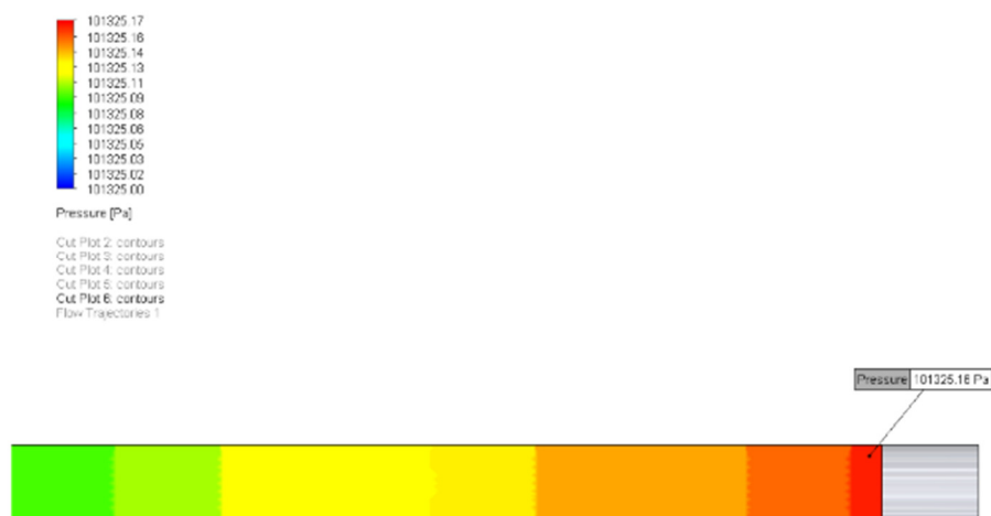
Figura 2: Distribuição do Campo de Pressão no Canal Microfluídico
