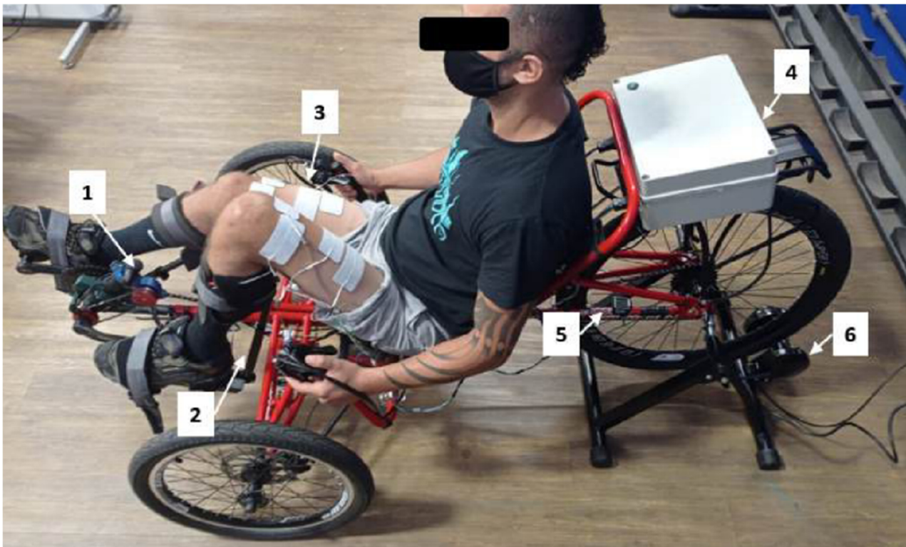
Figura 1. Triciclo e seus principais componentes: (1) Encoder incremental, (2) suporte para panturrilha, (3) eletrodos de superfície, (4) sistema de estimulação proprietário, (5) sensor de velocidade, (6) rolo de treinamento. Fonte:(MAGALHÃES et al., 2022; BEM-TE-VI, 2024)
