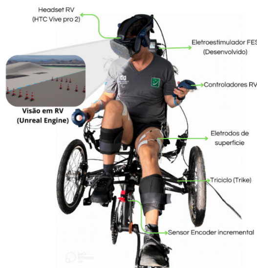
Figura 1. Representação geral do sistema: A plataforma V-FES-Cycling é composta por um triciclo adaptado para pacientes com lesão medular, onde a parte traseira do triciclo possui um circuito de estimulação FES que são conectados os eletrodos colocados nos músculos específicos dos membros inferiores. A parte frontal do triciclo é instrumentada com um sensor encoder incremental que mede o ângulo de pedalada. E o usuário do triciclo visualiza o ambiente em RV desenvolvido na UE por meio dos óculos ( Headset do HTC Vive pro 2 ) e consegue realizar algumas interações com as mãos por meios dos controladores.
