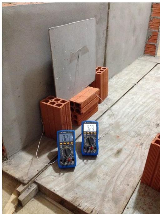
**Figura 10.** Posicionamento e instrumentação do brise para a realização dos experimentos.
