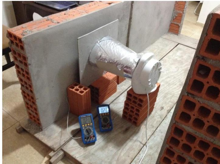
**Figura 11.** Acoplamento do aquecedor na parede em estudo.
