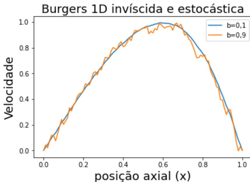
**Figura 2.** Velocidade adimensional simulada pela equação de Burgers invíscida e estocástica.
