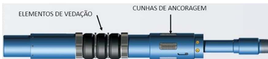
Figura 1. Packer genérico (adaptado do website da empresa B&S Oil Tools).
