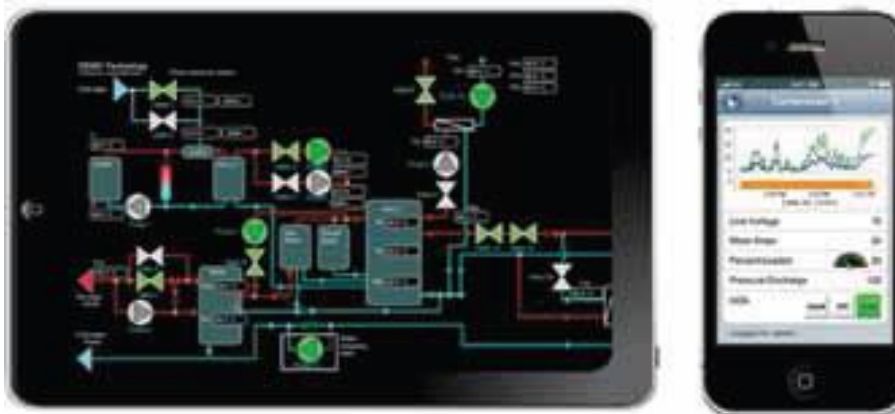
Figura 9. Acesso remoto de um sistema SCADA plotado em telas de dispositivos móveis. Fonte: PAIOLA, 2012.
