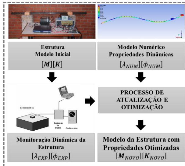
Figura 1: Processo de atualização dos modelos numéricos da viga
