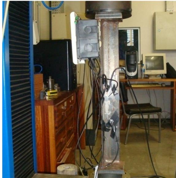
Figura 5. Protótipo em cantoneira para validação dos sensores ópticos.
