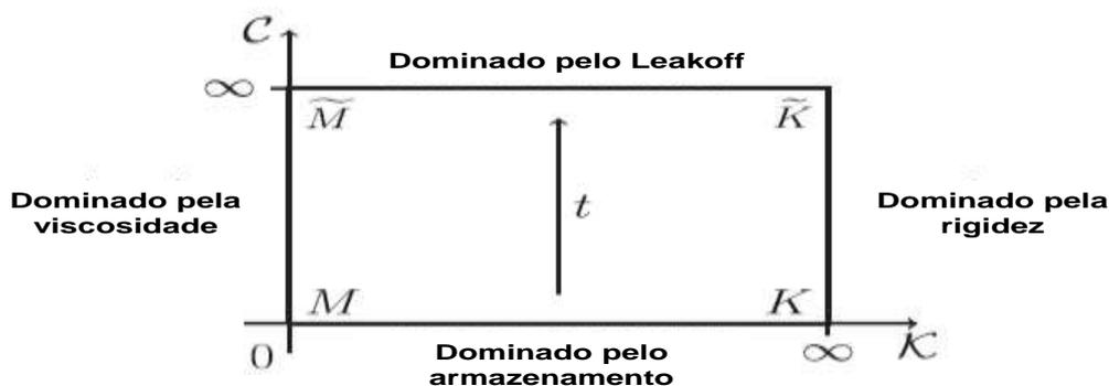
Figura 6: Regimes de propagação da fratura hidráulica (Carrier e Granet, 2012)
