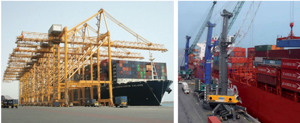
Figura 4. Principais equipamentos utilizados em terminais de contêineres – Portêineres e Guindastes Móveis Portuários (Fonte: Liebherr, 2016).
