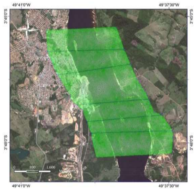
Figura 3. Malha de Elementos Finitos
