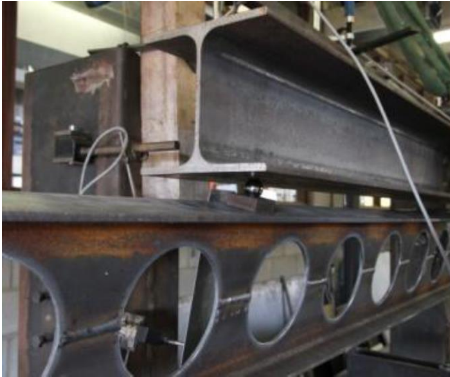
Figura 8. Flambagem lateral com torção de viga celular (Fonte: Sonck, 2014)
