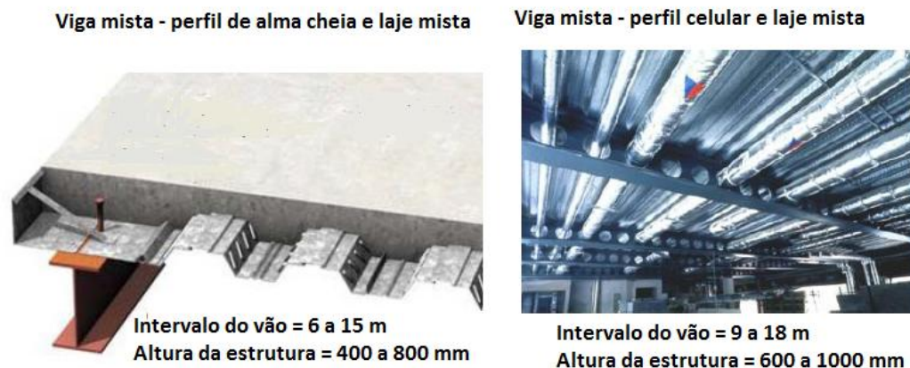
Figura 3. Comparação de vigas mistas de com perfis de alma cheia e celular.
