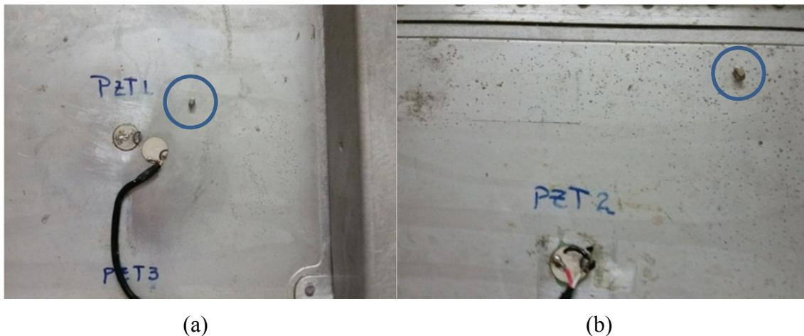
**Figura 3. Painel de alumínio com adição de massas simulando os danos**
