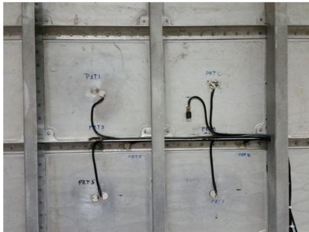
Figura 2. Painel de alumínio, com 4 PZTs, usado no painel
