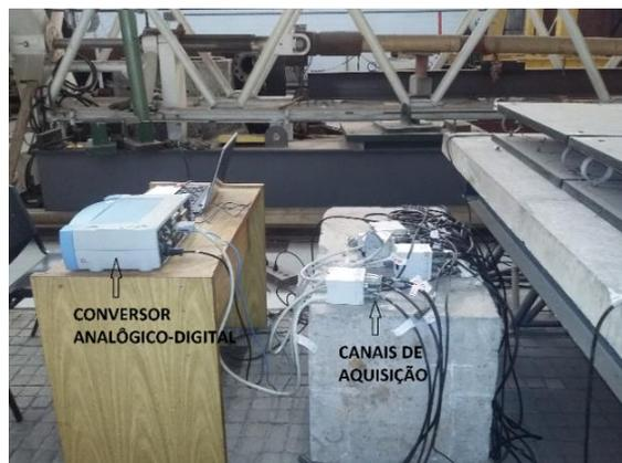
Figura 9: Equipamento usado para a aquisição e processamento dos sinais durante os testes (Vega, 2016)
