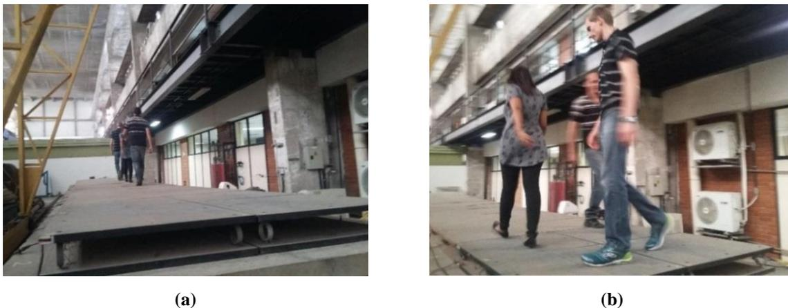
**Figura 12: Teste com três pessoas andando sobre a estrutura (a) Situação 1 (b) Situação 2**
