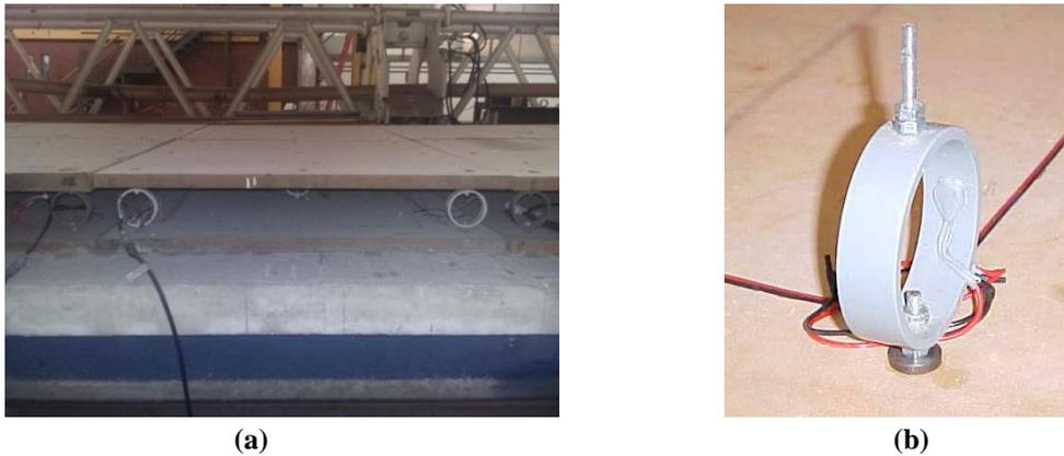
Figura 7: Instrumentação para medição da força aplicada: (a) Plataforma instrumentada para medição da força aplicada (Vega, 2016); (b) Anel instrumentado com extensômetros nas faces interna e externa (Fáisca, 2003)
