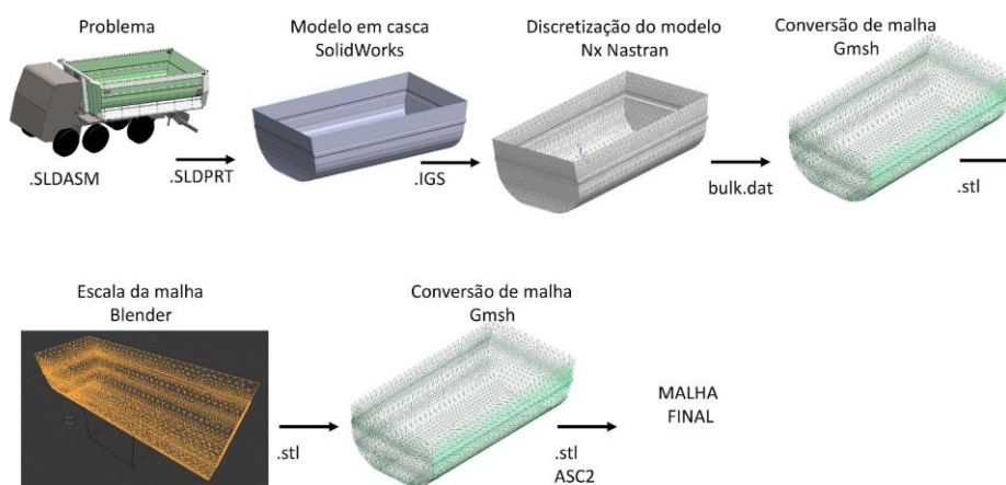
Figura 1. Metodologia de geração da malha para análise
