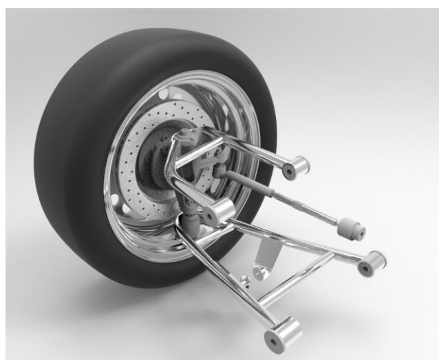
Figura 3. Modelagem de 1/4 de suspensão dianteira do veículo em ambiente CAD
