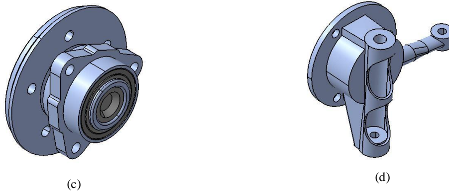
Figura 8. Desenho em CAD do \frac{1}{4} de suspensão do veículo a) bandeja inferior b) bandeja superior c) cubo da roda d) montante
