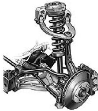
Figura 1. Suspensão com geometria Duplo A
