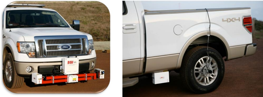
Figura 3. (a) Perfilômetro inercial com fixação frontal (b) Perfilômetro inercial com fixação lateral Fonte: SSI.
