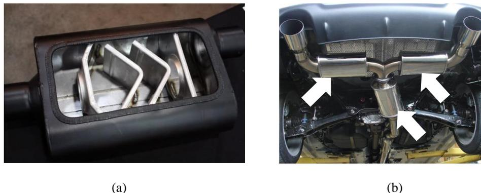
**Figura 1. (a) Exemplo de silenciador acústico reativo (b) Silenciador aplicados no sistema de exaustão de um automóvel (Fonte: Google Imagens).**
