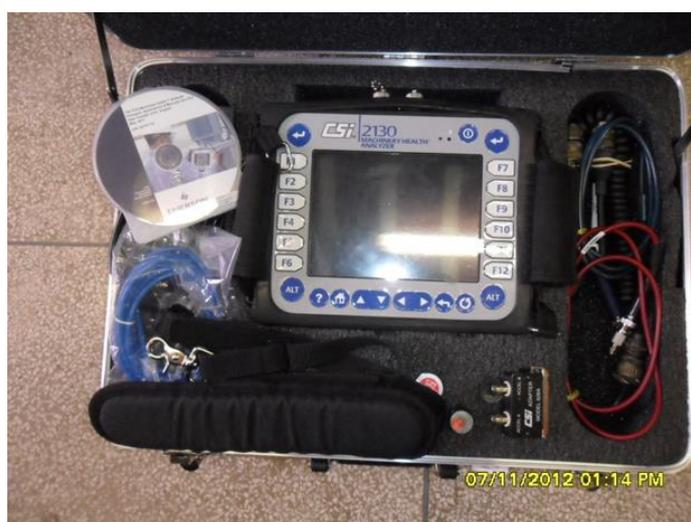
**Figura 3. Analisador de vibração utilizado na medição**
