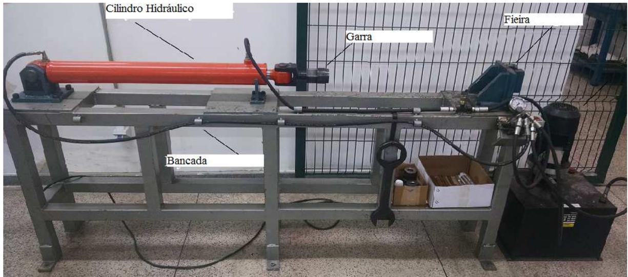
**Figura 5. Bancada de Trefilação**
