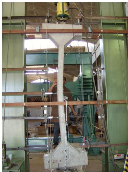
Figura 2 – Pilar sob flexão composta normal, ensaio realizado por Melo(2009)
