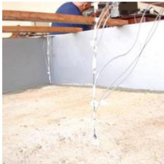
**Figura 2. Termômetros instalados no centro da forma**
