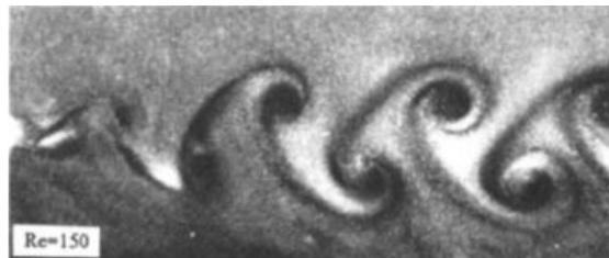
**Figura 1:** Desprendimento de vórtices já desenvolvidos para um cilindro fixo com coeficiente de Reynolds igual a 150. Retirada de Williamson (1996).
